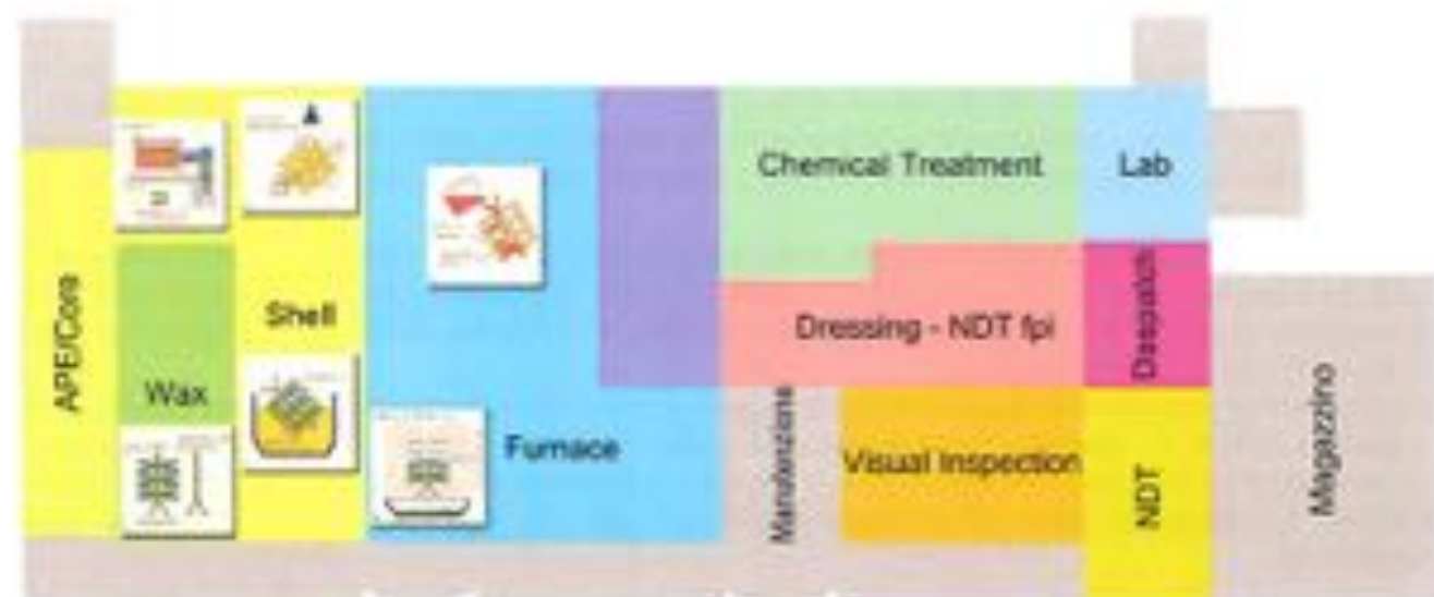
Figura 3: Schematizzazione del processo produttivo di "investment Casting" e microcasting a cera persa.
