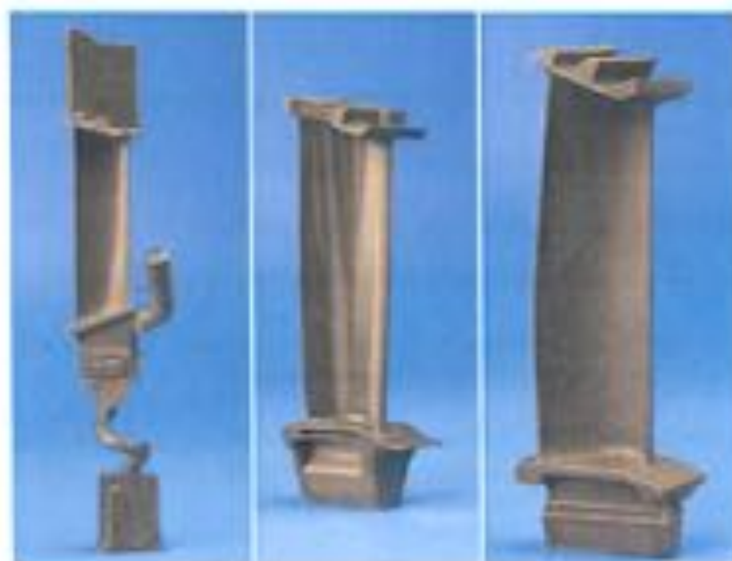
Figura 4. A sinistra, struttura monocristallina (DSX), al centro struttura direzionale (DS), dove sono evidenti i grani colorati che appaiono di diverso colore e a destra struttura equiassica (EQX), dove si notano i singoli piccoli grani, mediamente della stessa dimensione.
